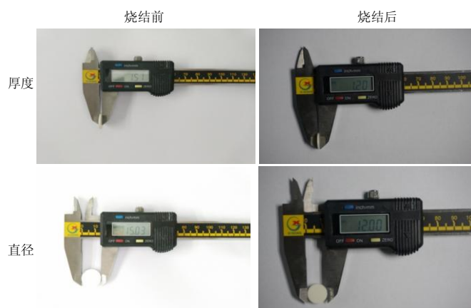
图注: 烧结前厚度为 1.51 mm, 烧结后厚度为 1.20 mm, 烧结前直径为 15.03 mm, 烧结后直径为 12.00 mm。
